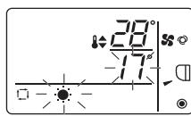
Druk op **[TEMP ▲]** of **[TEMP ▼]** terwijl de vooraf ingestelde temperatuur voor verwarmen knippert om de instelling te verhogen of te verlagen.
