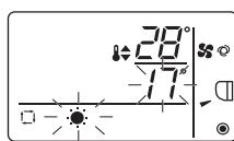
Mens displayet for den forudindstillede temperatur for opvarmning blinker, øges den forudindstillede temperatur for opvarmning, hvis du trykker på knappen **TEMP ▲**, og den forudindstillede temperatur for opvarmning sænkes, hvis du trykker på knappen **TEMP ▼**.
