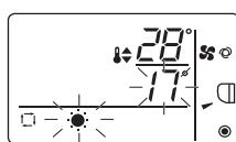
Mentre l'indicazione della temperatura preimposta per il riscaldamento lampeggia, premere il pulsante **[TEMP ▲]** per aumentare la temperatura preimposta per il riscaldamento. Premere il pulsante **[TEMP ▼]** per diminuire la temperatura preimposta per il riscaldamento.
