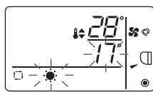
Lorsque l'affichage de la température programmée de chauffage clignote, appuyer sur le bouton **[TEMP ▲]** augmente la température programmée de chauffage et appuyer sur le bouton **[TEMP ▼]** diminue la température programmée de chauffage.
