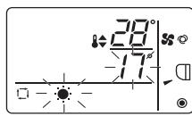
制热预设温度显示闪烁时，按 **TEMP ▲** 按钮可增高制热预设温度，按 **TEMP ▼** 按钮可降低制热预设温度。
