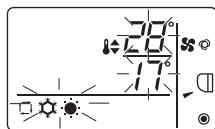
Lorsque l'affichage de la température programmée (refroidissement/chauffage) clignote, appuyer sur le bouton **[TEMP ▲]** augmente les températures programmées de refroidissement et de chauffage et appuyer sur le bouton **[TEMP ▼]** diminue les températures programmées de refroidissement et de chauffage.
