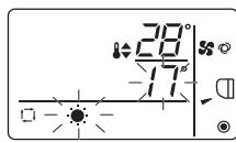
制熱預設溫度顯示閃爍時，按 **[TEMP. ▲]** 按鈕升高制熱預設溫度，按 **[TEMP. ▼]** 按鈕降低制熱預設溫度。
