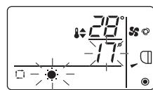
Isıtma ön ayar sıcaklığı görüntüsü yanıp sönerken **TEMP ▲** düğmesine basılırsa ısıtma ön ayar sıcaklığı artar ve **TEMP ▼** düğmesine basılırsa ısıtma ön ayar sıcaklığı azalır.
