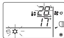
Se, enquanto o indicador da temperatura predefinida de arrefecimento está intermitente, premir o botão **iTEMP ▲**, aumenta a temperatura predefinida para arrefecimento. Se premir o botão **iTEMP ▼**, diminui a temperatura predefinida para arrefecimento.
